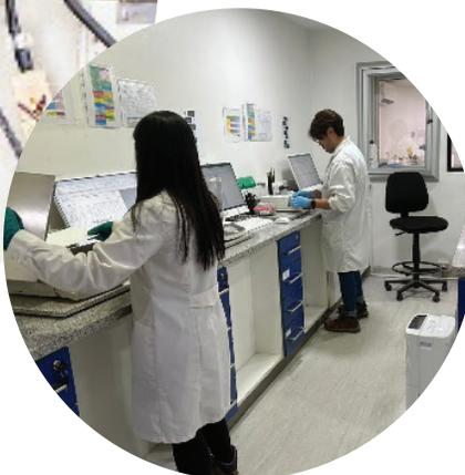
Foto 4. Análisis gravimétrico de filtros en laboratorio ALS en Chile
